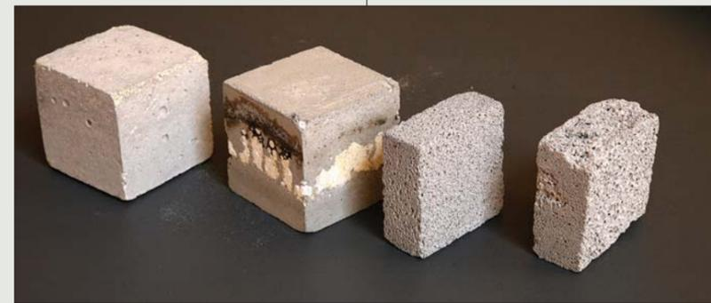
Кольского филиала РАН, мелкодисперсная высокопористая зола, получаемая от сжигания ВУТ, позволяет заместить до 18% цемента при изготовлении железобетонных изделий (см. фото).
